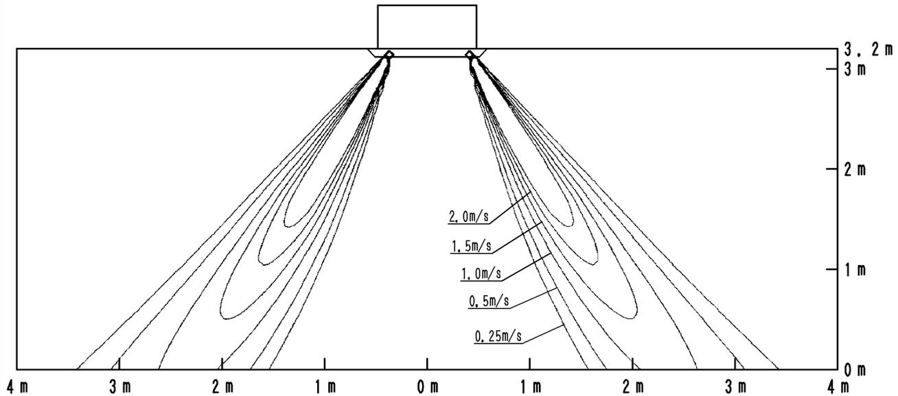
Распределение температуры воздушного потока при нагреве
