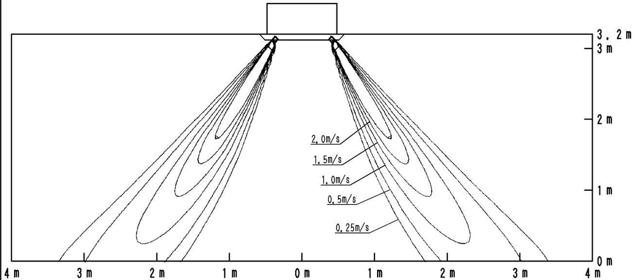
Распределение температуры воздушного потока при нагреве
