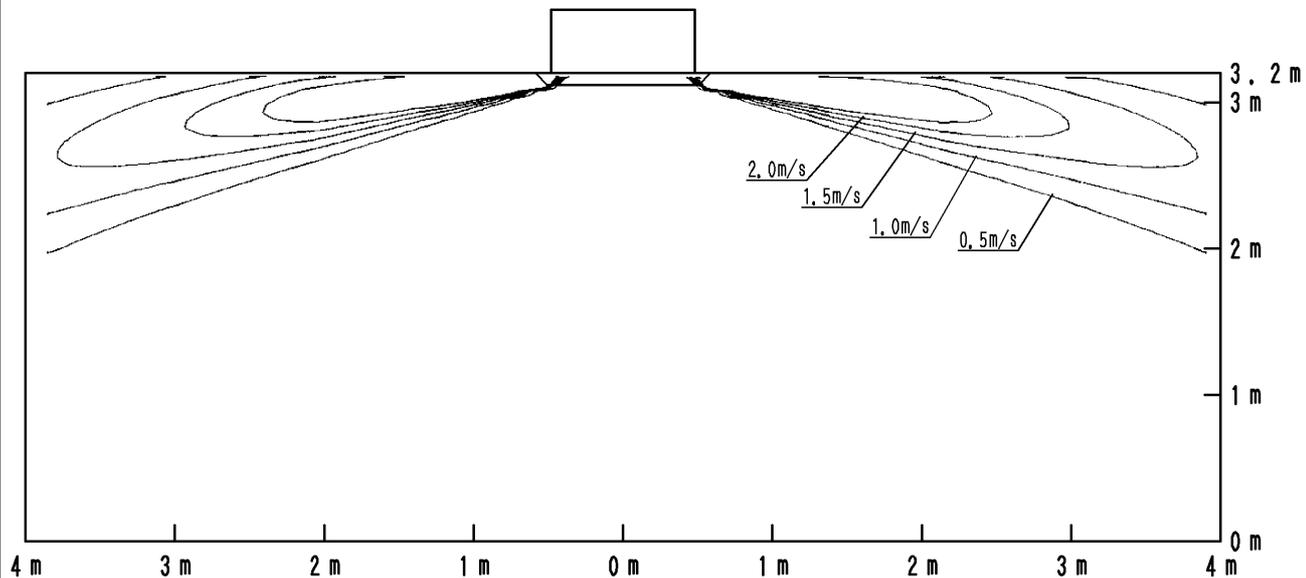
Распределение температуры воздушного потока при охлаждении
