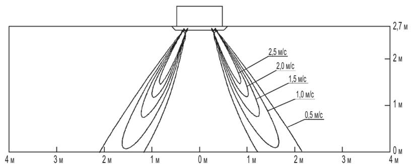
Распределение температуры воздушного потока при нагреве
